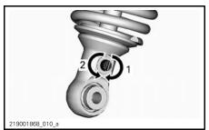
REBOUND DAMPING - BOTTOM OF SHOCK ABSORBER
