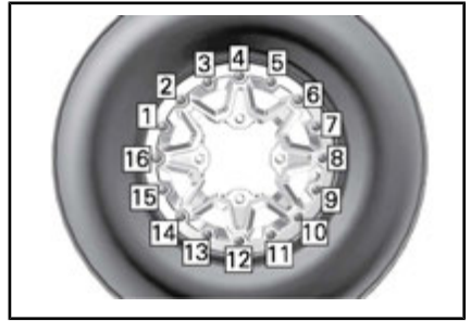
TYYPILLINEN - LOPULLINEN KIRISTYS- JÄRJESTYS
