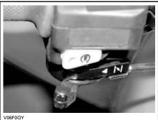
CHOKE LEVER IN THE FULL CHOKE POSITION
