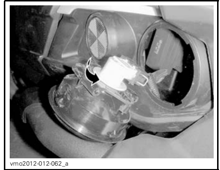
vm02012-012-062_a FAIRE TOURNER L'AMPOULE DANS LE SENS ANTIHORAIRE
