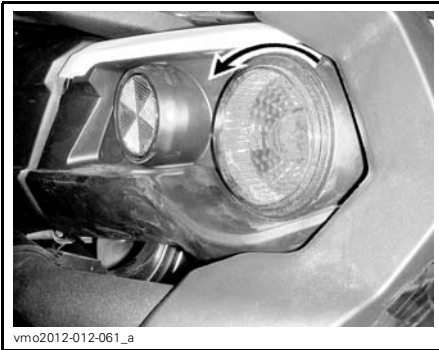
vm02012-012-061_a FAIRE TOURNER L'AMPOULE DANS LE SENS ANTIHORAIRE POUR L'ENLEVER
