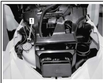
1. Tappo del serbatoio liquido refrigerante motore
