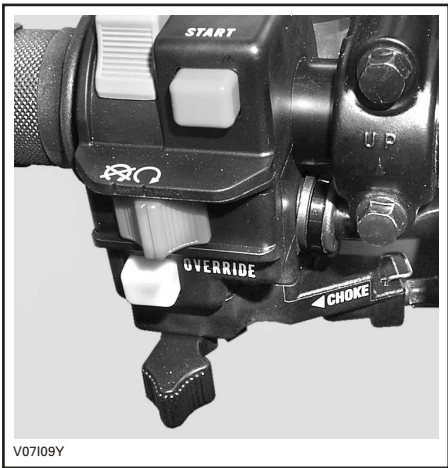
PALANCA DEL ESTRANGULADOR DE AIRE EN POSICIÓN DE ESTRANGULADOR ABIERTO
