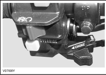
PALANCA DEL ESTRANGULADOR DE AIRE EN POSICIÓN DE ESTRANGULADOR CERRADO
