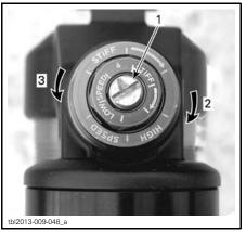
LOW SPEED COMPRESSION DAMPING (USE A SCREWDRIVER)
