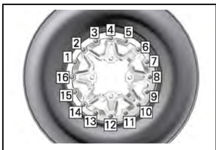
SITUAZIONE TIPICA - SEQUENZA DI SERRAGGIO FINALE
