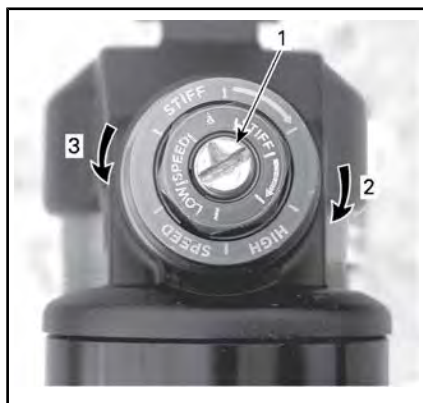
SMORZAMENTO IN COMPRESSIONE A BASSA VELOCITÀ (UTILIZZARE UN CACCIAVITE)
