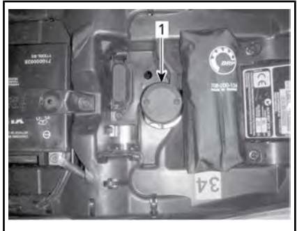
1. Serbatoio liquido dei freni posteriori
