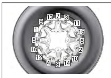
SITUAZIONE TIPICA - SEQUENZA DI SERRAGGIO
