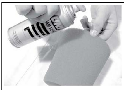
TÍPICO - ENGRASE CON ACEITE EL ELEMENTO DEL FILTRO DE ESPUMA
