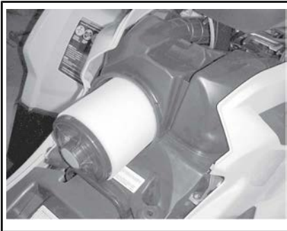
EXTRACCIÓN DEL FILTRO DE AIRE
