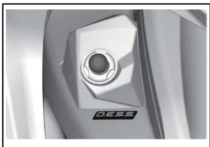
ANCLAJE D.E.S.S. DEL MOTOR
