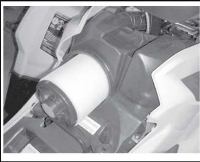
EXTRACCIÓN DEL FILTRO DE AIRE
