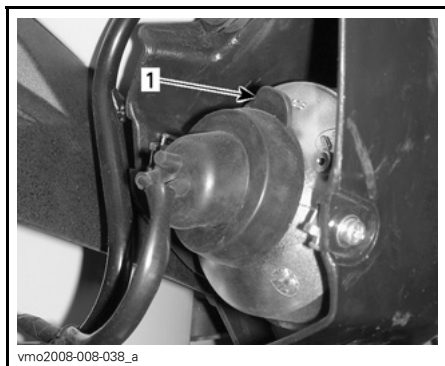
TA AV GUMMISKYDDET 1. Gummiskydd
