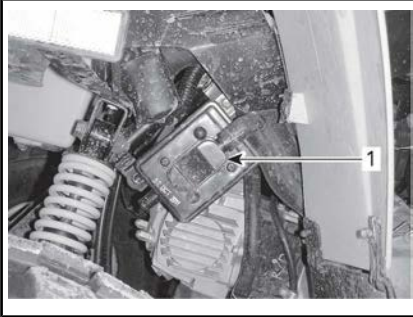
1. Valvola di iniezione dell'aria
