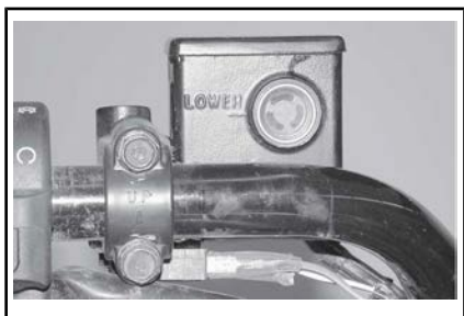
TÍPICO — DEPÓSITO DE LÍQUIDO DE FRENOS DE LA PARTE TRASERA, EN EL LADO IZQUIERDO
