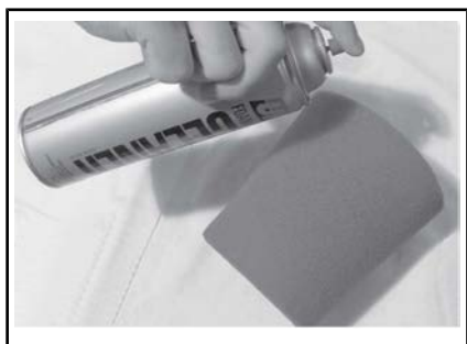
TÍPICO - ROCÍE EL ELEMENTO DE FILTRO POR DENTRO Y POR FUERA.
