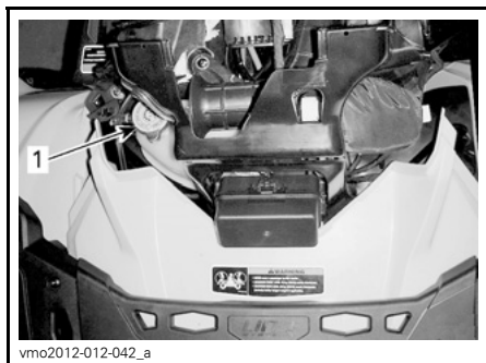
1. Moottorin jäähdytysnestesäiliön korkki
