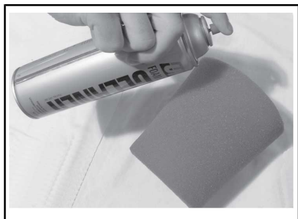
TÍPICO - BORRIFE O ELEMENTO DE ESPUMA POR DENTRO E POR FORA
