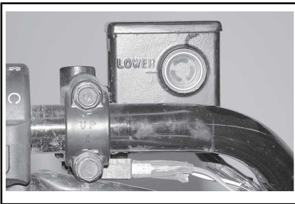
TÍPICO — RESERVATÓRIO DE FLUIDO DO FREIO TRASEIRO ESQUERDO
