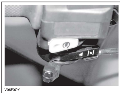
ALAVANCA DO AFOGADOR NA POSIÇÃO AFOGADO
