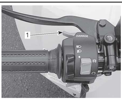
ALAVANCA DO AFOGADOR NA POSIÇÃO DESL.
