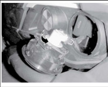
RUOTARE LA LAMPADINA IN SENSO ANTIORARIO
