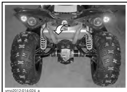
TYYPILLINEN - KIINNITYSKOHTA TAKANA
