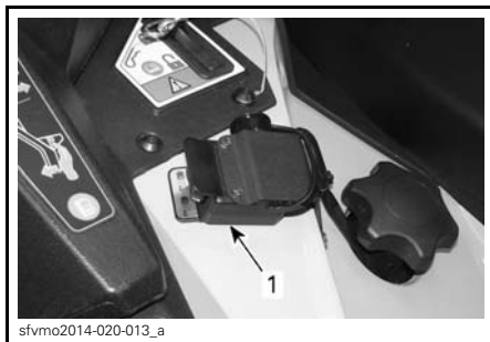
1. Vinssin kaukosäätimen kytkentä
