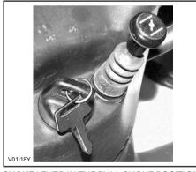
CHOKE LEVER IN THE FULL CHOKE POSITION
