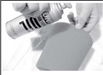
TYPISCH - FILTER MET OLIE SMEREN
