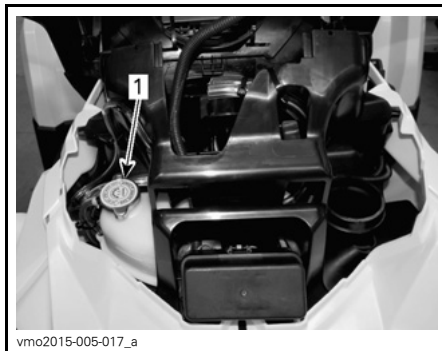
1. Moottorin jäähdytysnestesäiliön korkki
