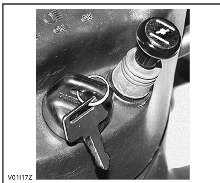
PALANCA DE POMO DEL ACELERADOR DE AIRE EN POSICIÓN DE CIERRE
