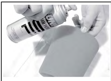
TYPISCH - FILTER MET OLIE SMEREN
