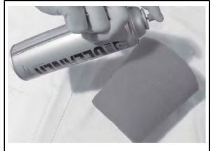
TYPISCH - SPUIT HET OP DE SCHUIMFILTER
