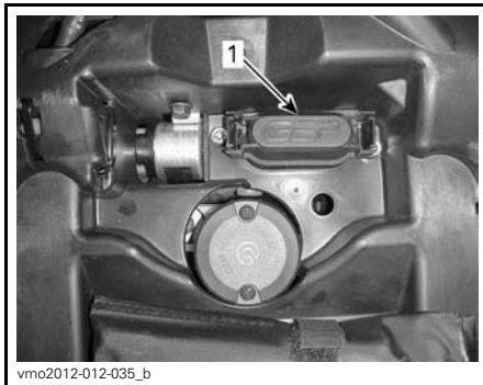
1. Lokk for sikringsholder bak
