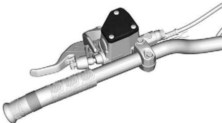
2. Entfernen Sie die Halteschrauben des Behälterdeckels.
