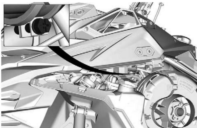
4. Bauen Sie die Halteschrauben des oberen Karosseriebaumoduls aus.
