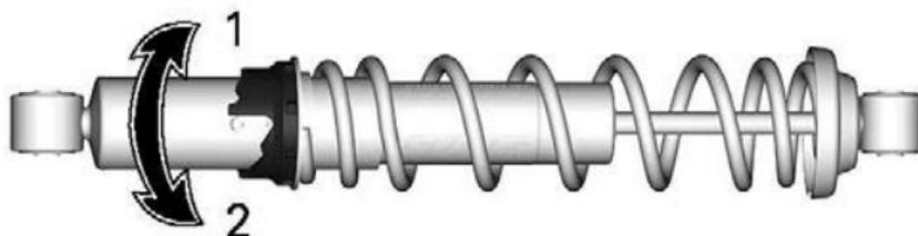
1. Vorspannung erhöhen
