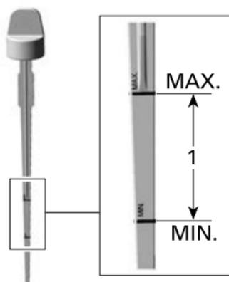
1. Ölfüllstand zwischen MIN und MAX.
