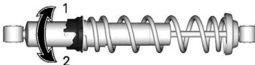
1. Vorspannung erhöhen
