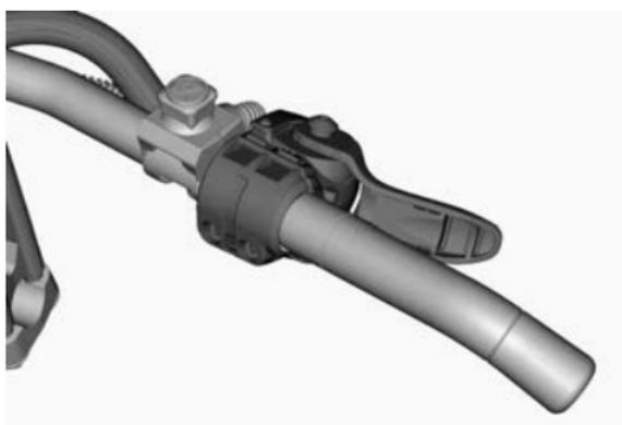
**GASHEBELPOSITION FÜR FINGERBETÄTIGUNG**
