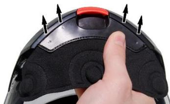
2. ネックロールを取り外すには、ネックロールの片側を慎重に上方向に引いて、矢印で示されているプラスチックのスナップ固定部を解除します。
