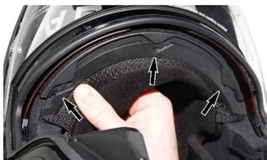
2. A continuación, coloca dentro del casco el revestimiento para la cabeza.
