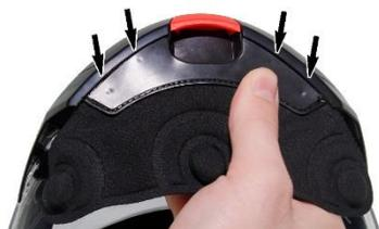
2. Presiona uno a uno los broches plásticos de presión con forma de flecha, para asegurarte de que todos encajen en la carcasa de plástico del barbiquejo, tal como se muestra en la ilustración.
