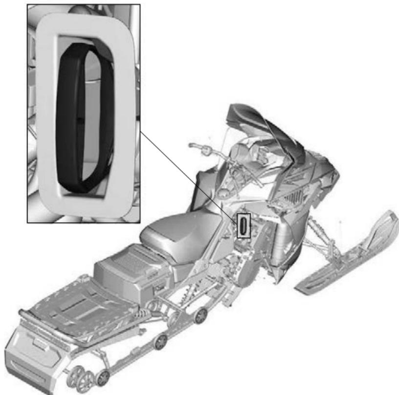
Hierbei handelt es sich um einen Startergriff mit automatischer Aufwicklung, der sich auf der rechten Seite des Motorschlittens unter der Seitenabdeckung befindet. Öffnen Sie das rechte Seitenteil, um auf den Rückholgriff zugreifen zu können. Siehe *Seitenabdeckungen ausbauen* in diesem Unterabschnitt. Zum Betätigen des Mechanismus ziehen Sie langsam am Griff bis Sie einen Widerstand spüren. Ziehen Sie dann energisch und kraftvoll. Geben Sie den Griff langsam wieder frei.
