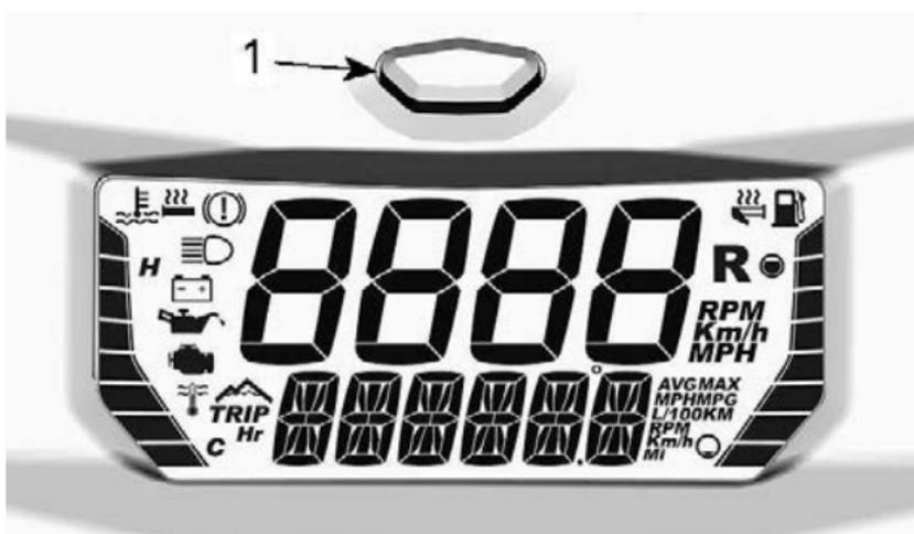
1. Modus-Taste des Anzeigeeinstruments
