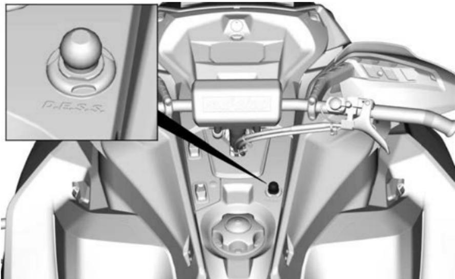
Die Kappe der Sicherheitsleine muss sicher am Motor-aus-Schalter einrasten, damit der Betrieb des Fahrzeugs möglich ist.
