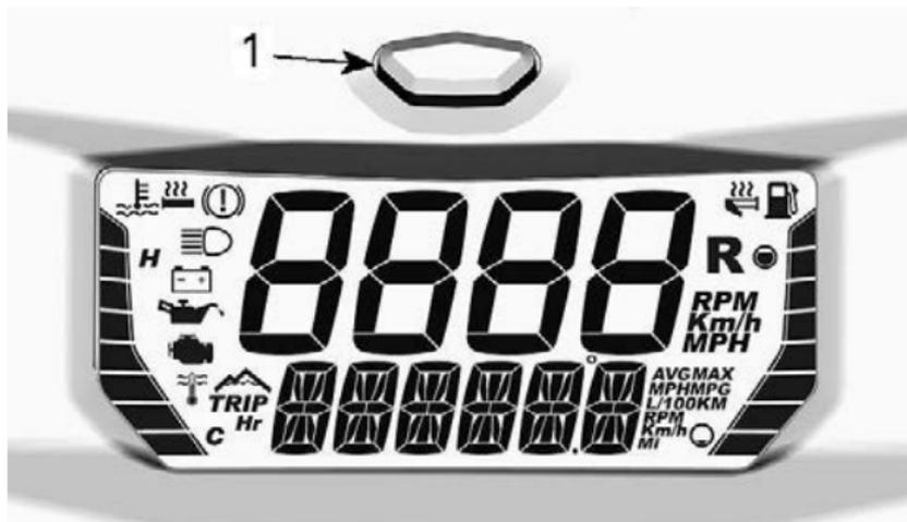
1. Modus-Taste des Anzeigeinstruments
