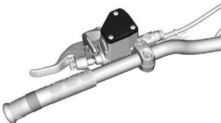
2. Entfernen Sie die Halteschrauben des Behälterdeckels.
