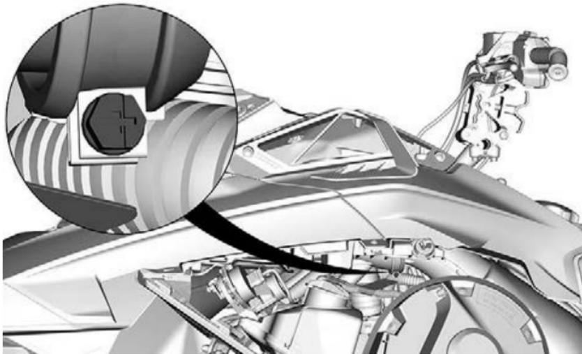
7. Entfernen Sie die Halteschrauben des oberen Karosseriemoduls auf beiden Seiten.
