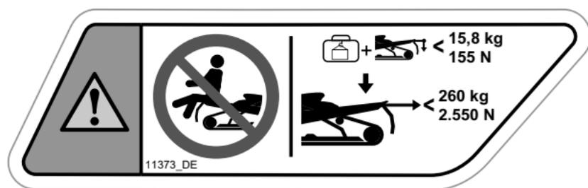
**MAXIMALE ZULADUNG UND ZUGLAST - WARNSCHILD**
