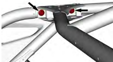
FIXATIONS LATÉRALES ARRIÈRE - TYPIQUE
