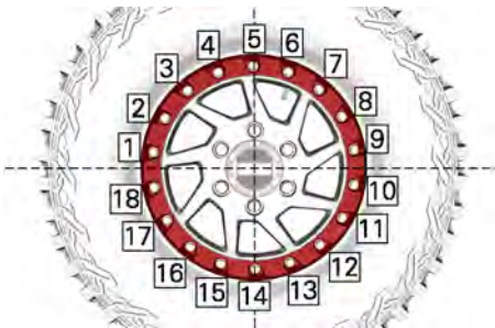
TYPIQUE - SÉQUENCE DE SERRAGE FINAL
