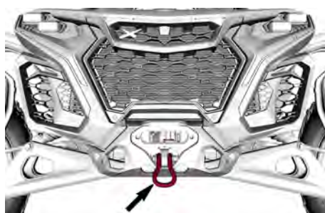
CROCHET DE RÉCUPÉRATION AVANT
