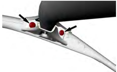
FIXATIONS LATÉRALES AVANT — TYPIQUE
