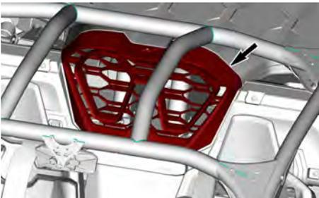
7. Bauen Sie die Kunststoffnieten und Schrauben, mit denen die Luftansaugbaugruppe am Gepäckträger befestigt ist. Bauen Sie anschließend die Luftansaugbaugruppe aus.
