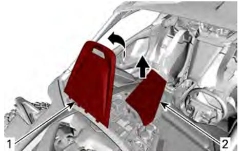
1. Abdeckung des Sicherungskastens
