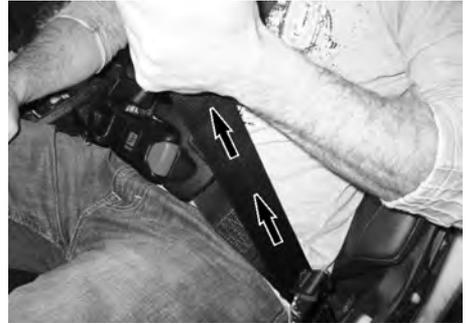
3. Um den Sitzgurt zu lösen, halten Sie mit einer Hand den Beckengurt und ziehen den roten Riemen nach aussen.
