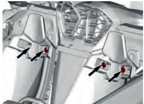
4. Entfernen Sie die vier Schrauben, zwei hinter jedem Sitz, mit denen die Ladeluftkühlerhalterung an der
