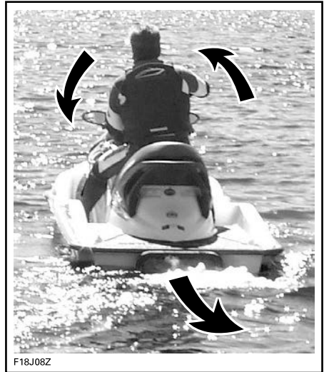
TYPISCH - LENKRICHTUNG BEIM ZURÜCKSETZEN UMGEKEHRT
