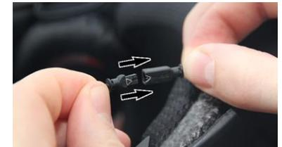
**B.6.** 両方のスピーカーケーブルがライナーの後ろを通過しており、ヘルメット脱着時の妨げにならないことを確認します。
