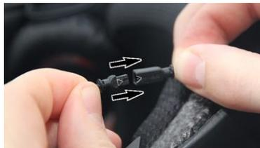
**A.8.** 両方のスピーカーケーブルがライナーの後ろを通過しており、ヘルメット脱着時の妨げにならないことを確認します。
