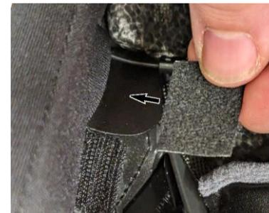
2. イソプロピルアルコールで表面をきれいにして、ヘルメット内のクランプの金属部分に四角形の Velcro テープを貼り、テープを均等に押し付けます。
