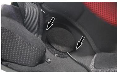
3. 上記手順で取り付けした Velcro アタッチメントにスピーカーを取り付けます。スピーカーの配線がヘルメット後部に向いていることを確認してください。
