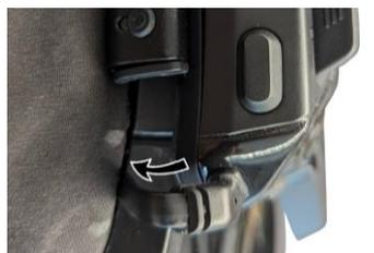
5.OXYGEN FLOW ヘルメットの場合は、保護カラーの赤いアタッチメントの後ろにメインモジュールを配置するようお勧めします（ヘルメットシェルと保護カラーの間にクランプを通してください）。
