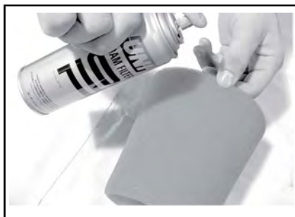
TÍPICO - LUBRIQUE EL FILTRO DE ESPUMA.
