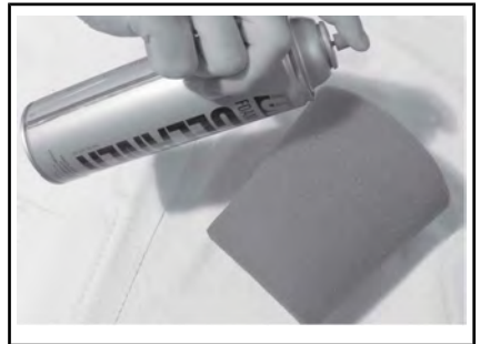
TÍPICO - ROCÍE EL FILTRO DE ESPUMA.
