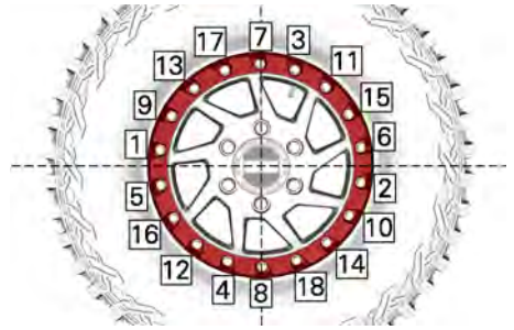
SITUAZIONE TIPICA - SEQUENZA DI SERRAGGIO
