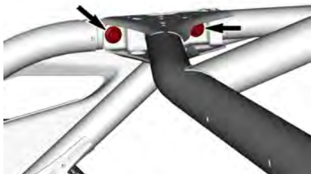
DISPOSITIVI DI FISSAGGIO LATERALI POSTERIORI – CONFIGURAZIONE TIPICA
