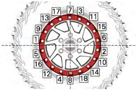
SITUAZIONE TIPICA - SEQUENZA DI SERRAGGIO
