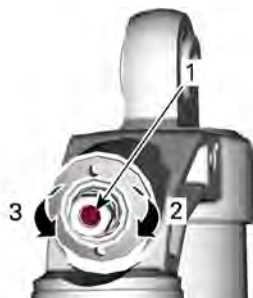
低速压缩阻尼 (使用螺丝刀)
