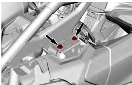
DISPOSITIVI DI FISSAGGIO POSTERIORI – CONFIGURAZIONE TIPICA
