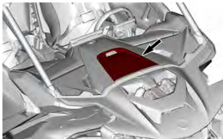
COPERTURA DELLA SCATOLA FUSIBILI ANTERIORE
