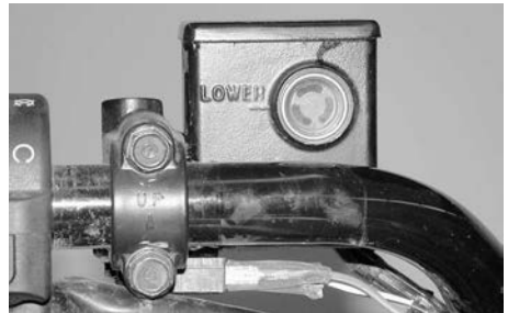
TYPISCH — ACHTERREM-VLOEISTOFRESERVOIR LINKS
