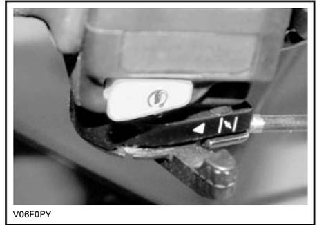
**LEVA DEL DISPOSITIVO DELL'ARIA IN POSIZIONE OFF**
