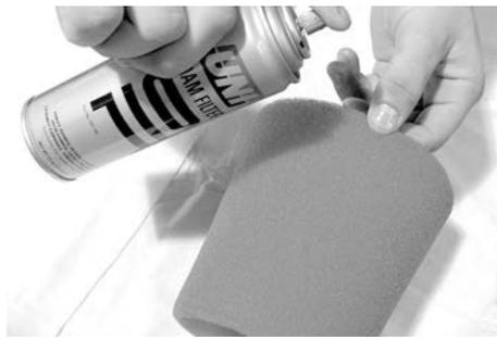
**CONFIGURAZIONE TIPICA - OLIARE L'ELEMENTO FILTRO IN MATERIALE ESPANSO**
