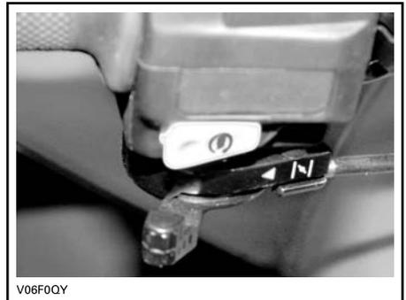
**LEVA DEL DISPOSITIVO DELL'ARIA IN POSIZIONE COMPLETA**
