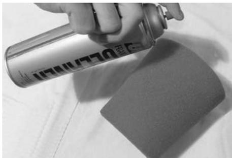
**CONFIGURAZIONE TIPICA - SPRUZZARE L'INTERNO E L'ESTERNO DELL'ELEMENTO IN MATERIALE ESPANSO**
