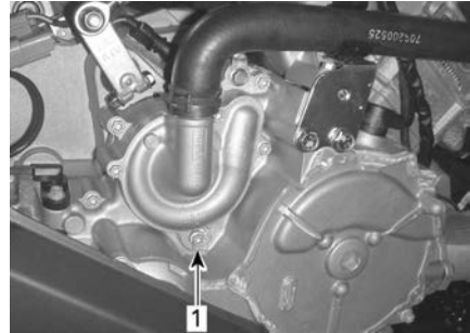
1. Tapón de drenaje de refrigerante
