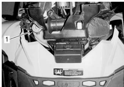
1. Réservoir du liquide de refroidissement
