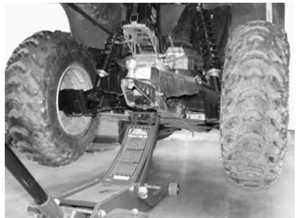
TYPIQUE — POINT DE LEVAGE ARRIÈRE
