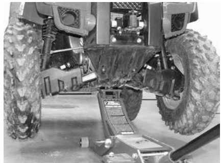
TYPIQUE — POINT DE LEVAGE AVANT
