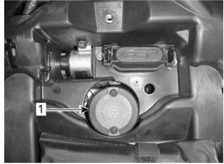
1. Behälter für Bremsflüssigkeit der hinteren Bremse
