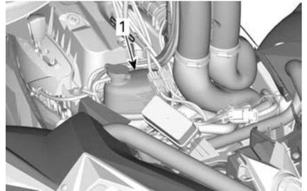
1. Reservatório do líquido de arrefecimento do motor
