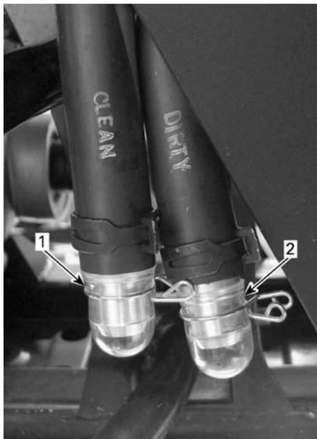
1. Reservatório de drenagem da caixa do filtro de ar
