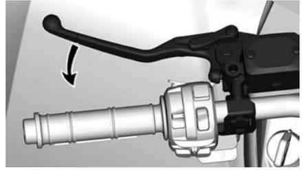
A frenagem é proporcional à força aplicada na alavanca.
