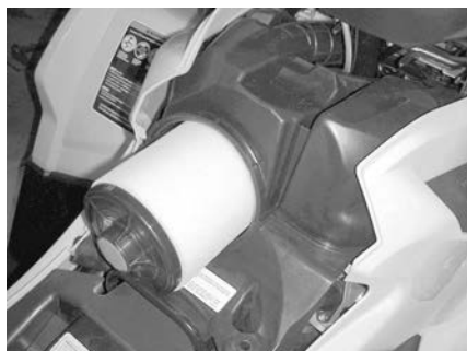
空气滤清器拆卸
