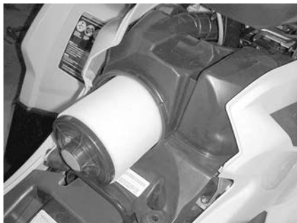
空气滤清器拆卸
