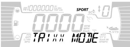
Der Trixx-Modus sorgt für sofortige Gasannahme und schnellere Beschleunigung als der STANDARD-FAHRMODUS. Der Trixx-MODE erhöht auch die Reaktion des IBR. Die Rückfahrgeschwindigkeit wird erhöht und das Bremsverhalten ist anders.
