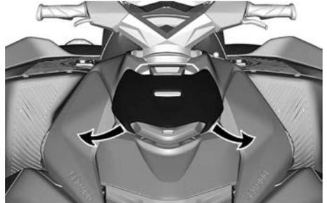
4. Die Abdeckung nach unten schieben ( in Richtung des Vorderteils des Wasserfahrzeugs).
