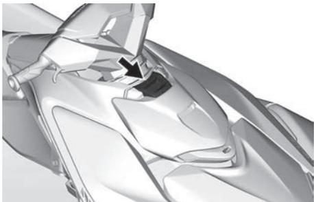
4. Stellen Sie sicher, dass die vordere Lasche im vorderen Konsolenschlitz verankert ist.
