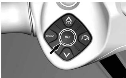
Permite ativar o sistema iDF. Consulte *Ativação do sistema inteligente de bomba livre de detritos* na seção *Instruções de Operação*.
