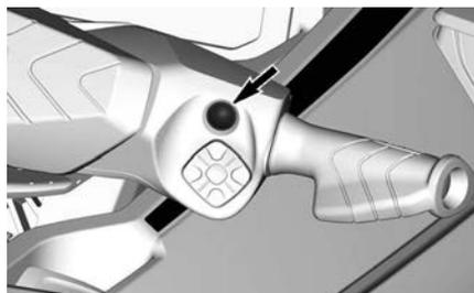
Ele permite um acesso rápido ao BRP Connect. Cada clique troca entre a exibição de apps e a exibição de funções do painel multifuncional.
