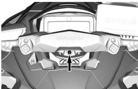
Para permitir a partida do motor, a tampa do cabo de segurança deve estar encaixada firmemente no interruptor de desligamento do motor.
