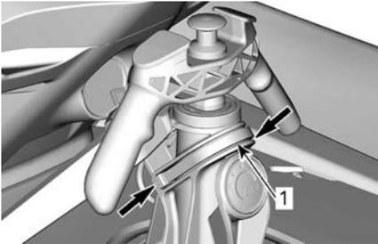
**TÍPICO - EMPURRE NA DIREÇÃO DA PROA PARA DESTRAVAR E REMOVER O MASTRO**
