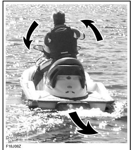
TYPEBILDE – STYRERETNINGEN ER MOTSATT NÅR DU RYGGER
