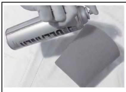
SITUAZIONE TIPICA - SPRUZZARE L'ELEMENTO IN MATERIALE ESPANSO
