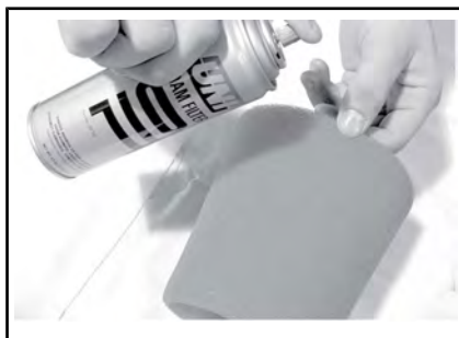
SITUAZIONE TIPICA - LUBRIFICARE L'ELEMENTO FILTRANTE IN MATERIALE ESPANSO
