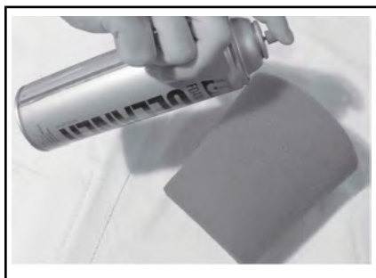
TYPISCH - SCHAUMSTOFFFILTERELEMENT BESPRÜHEN
