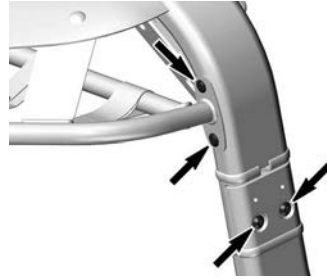
VIS DE LA STRUCTURE DU BIMINI À L'AVANT - CÔTÉ GAUCHE
